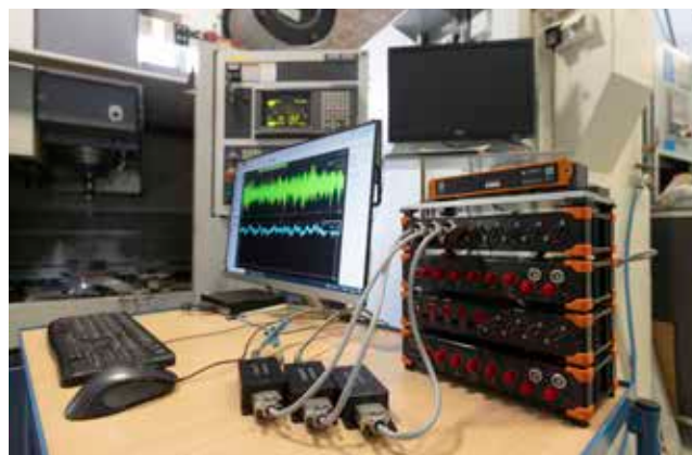
Slika 3 : Visoko kvalitetni merilni instrumentalni sistem za zajem podatkov, testiranje in kontrolo fizičnih fenomenov proizvodnih procesov (Foto: IFP, d. o. o.)
