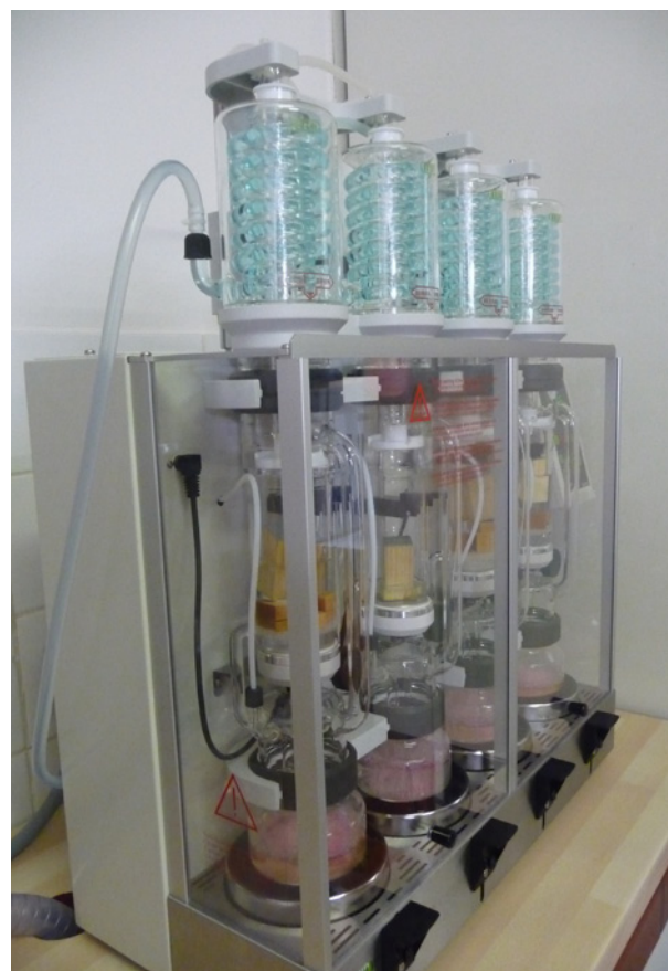
Slika 2. Ekstrakcijski aparat Soxhlet podjetja Büchi (B-811 LSV 230V)
