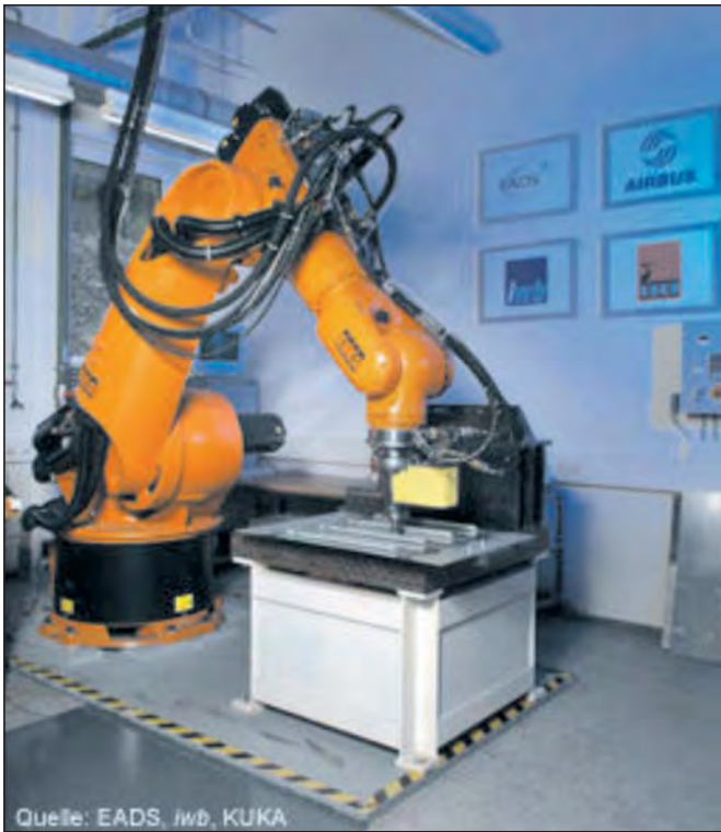
Slika 2. Robot z varilno glavo za varjenje z gnetenjem
