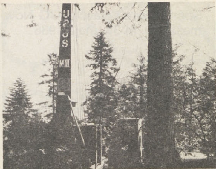
Žični žerjav URUS na spravilu lesa v Delnicah. S Šumskim gospodarstvom Delnice smo sklenili dogovor za spravilo okrog 1.200 m 3 lesa na težko dostopnem terenu. (Vse fotografije v tej številki: M. Bajt.)
