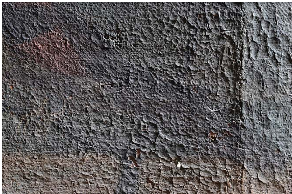
Slika 17: Fotografija s stransko osvetlitvijo je izraziteje prikazala dvignjene robove razpok.
