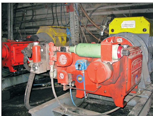
Slika 6. Hidravlična črpalka Hauhinco 3K125-50
