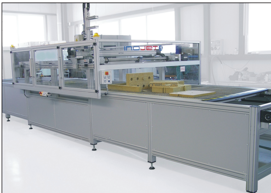
Slika 1. INOJET – portalna izvedba z dvostransko pomično mizo
