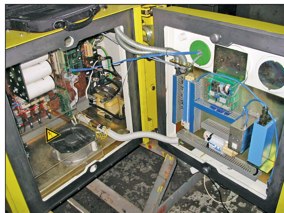
Slika 5. Izvedba močnega pretvornika v eksplozijsko varnem Ex-ohišju
