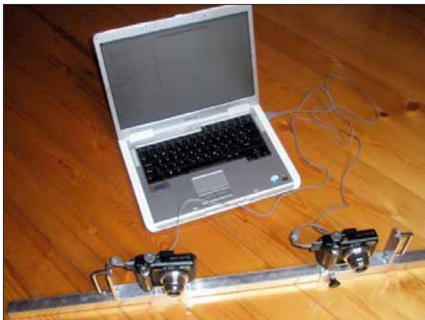
Slika 1. Stereoskopski sistem dveh kamer Canon PowerShot A640
