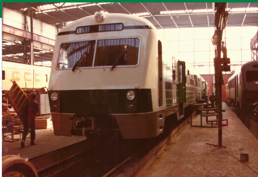
Dizelski motorni vlak z aluminijasto konstrukcijo, izdelan za ŽG Ljubljana
