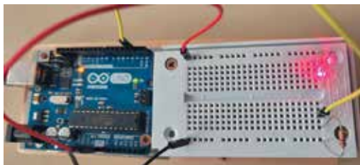
Sliki 14 in 15: Priklop fotovoltaičnega elementa med priključka GND in A0 ter branje napetosti na njem. Vezje za ugotavljanje osvetljenosti/neosvetljenosti fotodiode s pomočjo branja stanja na digitalnem vходу št. 2.
