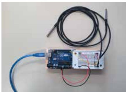
Slika 16: Priklop dveh vodoodpornih termometrov na krmilnik.
