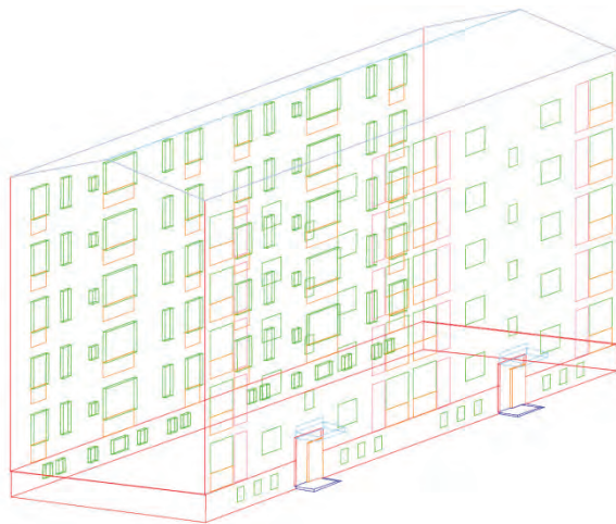
Slika 6: Žični model obravnavane stavbe – izmera TPS.
