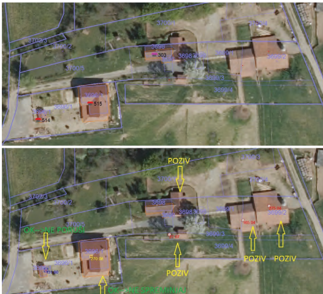
Slika 1: Primer prikaza kombinacije podatkov AIS z obstoječimi podatki geodetskih evidenc v programu GeoPro. V zgornjem delu slike je prikaz stavb, ki so v zemljiškem katastru evidentirane z vrstama rabe 220-ZPS (stavbi 514 in 515) in 221-ZPS* (stavba 303). V spodnjem delu slike so prikazane točkovne oznake analize AIS za nove, spremenjene in porušene stavbe z dodanim slikovnim komentarjem glede ustrezne aktivnosti geodetske uprave. Opisni številčni podatek ob točkovni oznaki AIS v sliki vsebuje površino in višino stavbe – na primer podatek 275.04 na stavbi v desnem delu slike pomeni novo stavbo s površino tlorisa stavbe 275 m 2 in z višino stavbe 4 metre (vir: OGU Murska Sobota, april 2018).
