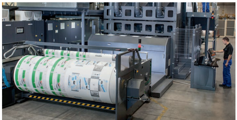
Sodobna digitalna rotacija za tisk embalaže, HP PageWide Web Press T1100S, razvita v sodelovanju podjetij HP in KBA-Digital & Web Solutions.
