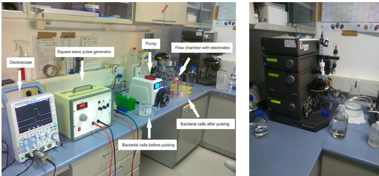
**Opis.** Pogoji za odstranjevanje bakterij in virusov iz vodnih vzorcev, ki so bili optimirani tekom projekta in vključujejo metodo pulzirajočega električnega polja (PEF) in CIM monolitne kolone, so bili uspešno implementirani na laboratorijskem nivoju. S kombinacijo obeh metod smo iz vode, kamor smo umetno dodali bakterije E. coli in Rotaviruse le-te uspešno odstranili; uspešnost odstranjevanja bakterij E. coli je bila 98%, odstranjevanje Rotavirusov pa 100%.
