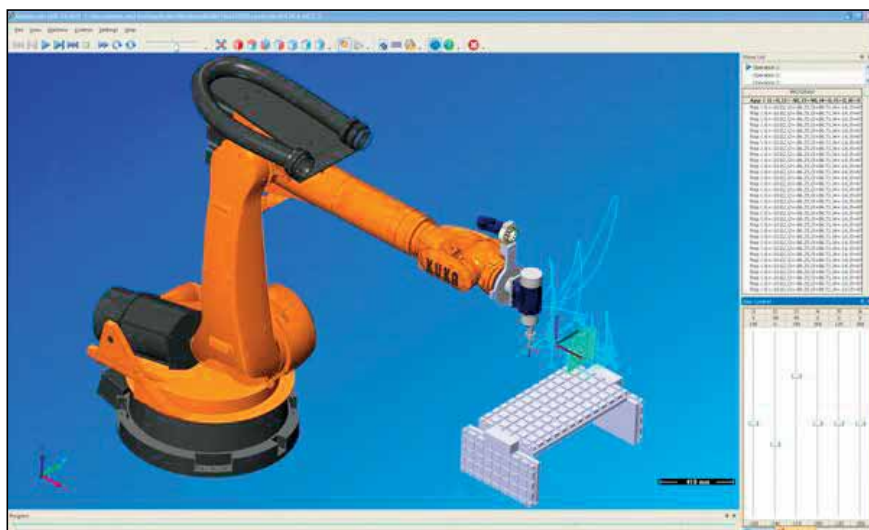
Slika 4. Robot v simulacijskem okolju Robotmaster
