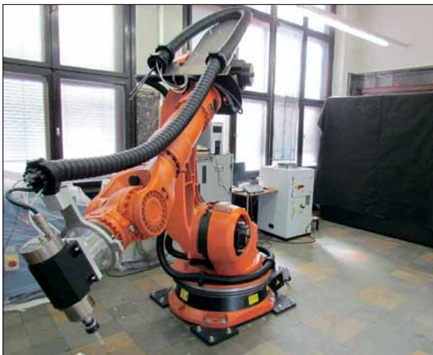
Slika 1. Robotska celica s komponentami in frezalno glavo
