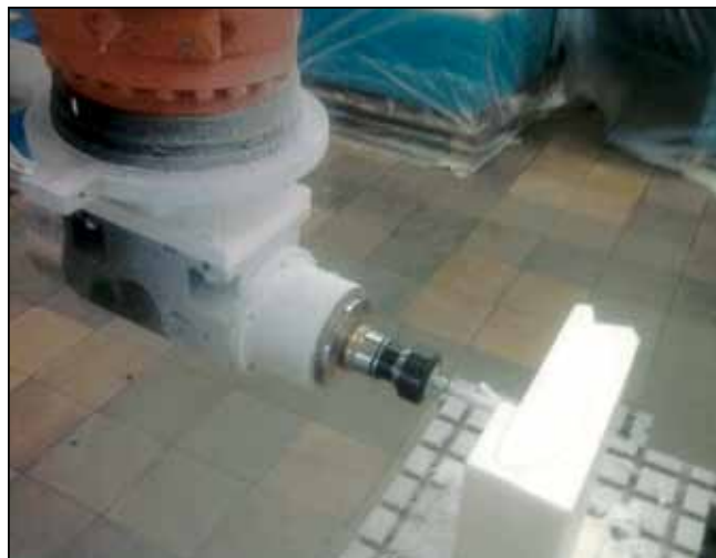
Slika 5. Freziranje obdelovanca lopatice
