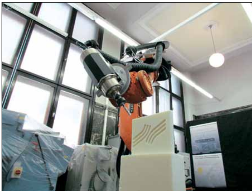
Slika 2. Lopatica z robotskim manipulatorjem
