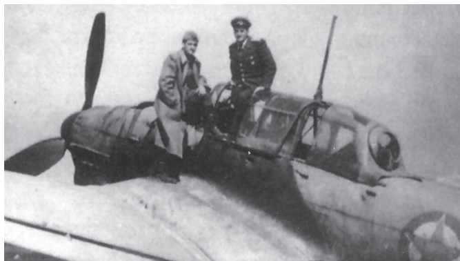
Štuka na letališču Pančevo, posneta jeseni 1945. Letalo ima spet zastekljeni zadnji del kabine in nameščeno strojnico. Prav tako ima nove, povojne oznake JVL. (Arhiv Šimeta Oštrića)
