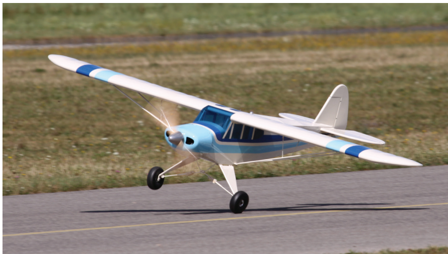
Piper Pa-14 med vožnjo z enim kolesom po stezi. Maketa v merilu 1 : 3,8 ima razpetino kril 280 cm in tehta 19 kg, poganjata pa jo dva elektromotorja.
