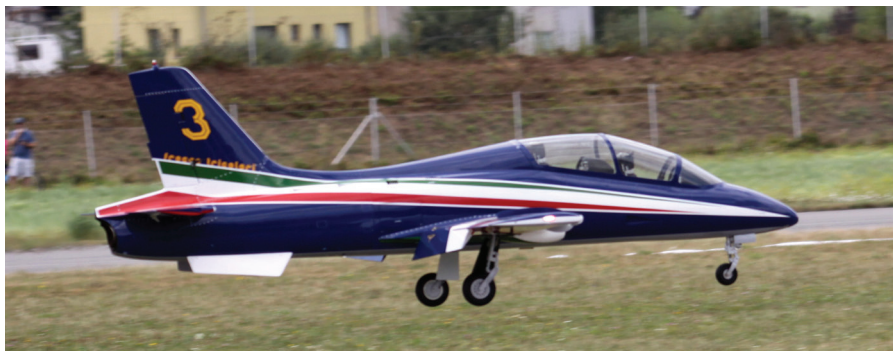
MB 339 italijanske akrobatske skupine Frece tricolori med pristajanjem. Model Avstrijca Antona Mauracherja ima razpetino kril 3 m, tehta 25 kg, poganja pa ga reaktivni motor s potisno silo 220 N.
