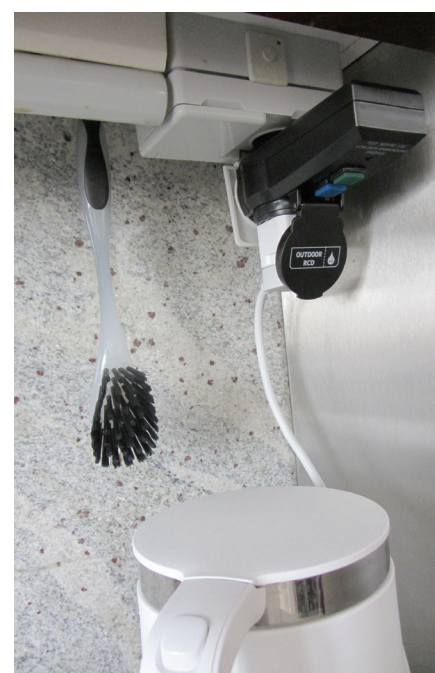
S FID-stikalom, ki ga vstavimo v običajno 230-voltno omrežno vtičnico, je varnejša uporaba marsikatere električne naprave.
