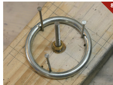
Priprava na spajkanje
