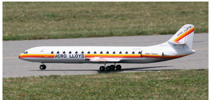
Maketa potniškega letala caravelle avstrijskega modelarja Daniela Tammerla je dolga 230 cm, poganjata pa jo dva impellerska elektromotorja, nameščena v motorskih gondolah ob trupu.
