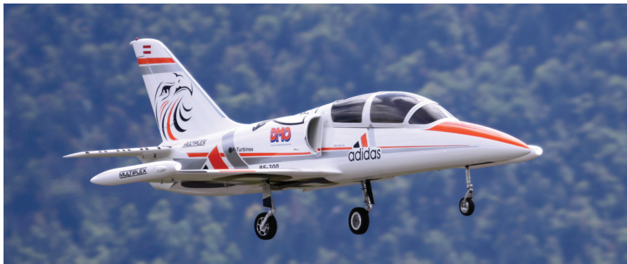
Albatros L-39, maketa češkega vojaškega letala, izdelana v merilu 1 : 3,5, meri čez krila 2,70 m, dolga je 3,50 m, tehta skoraj 25 kg, poganja pa jo reaktivni motor s potisno silo 300 N. Raimund Ganzer iz Avstrije je z njo dosegel drugo mesto v kategoriji reaktivnih letal.
