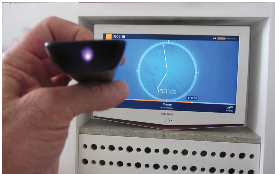
Hiter preizkus delovanja daljnjčka. Svetloba LED-diode, ki se pojavi na zaslonu digitalnega fotoaparata, je znak, da daljnjček deluje.
