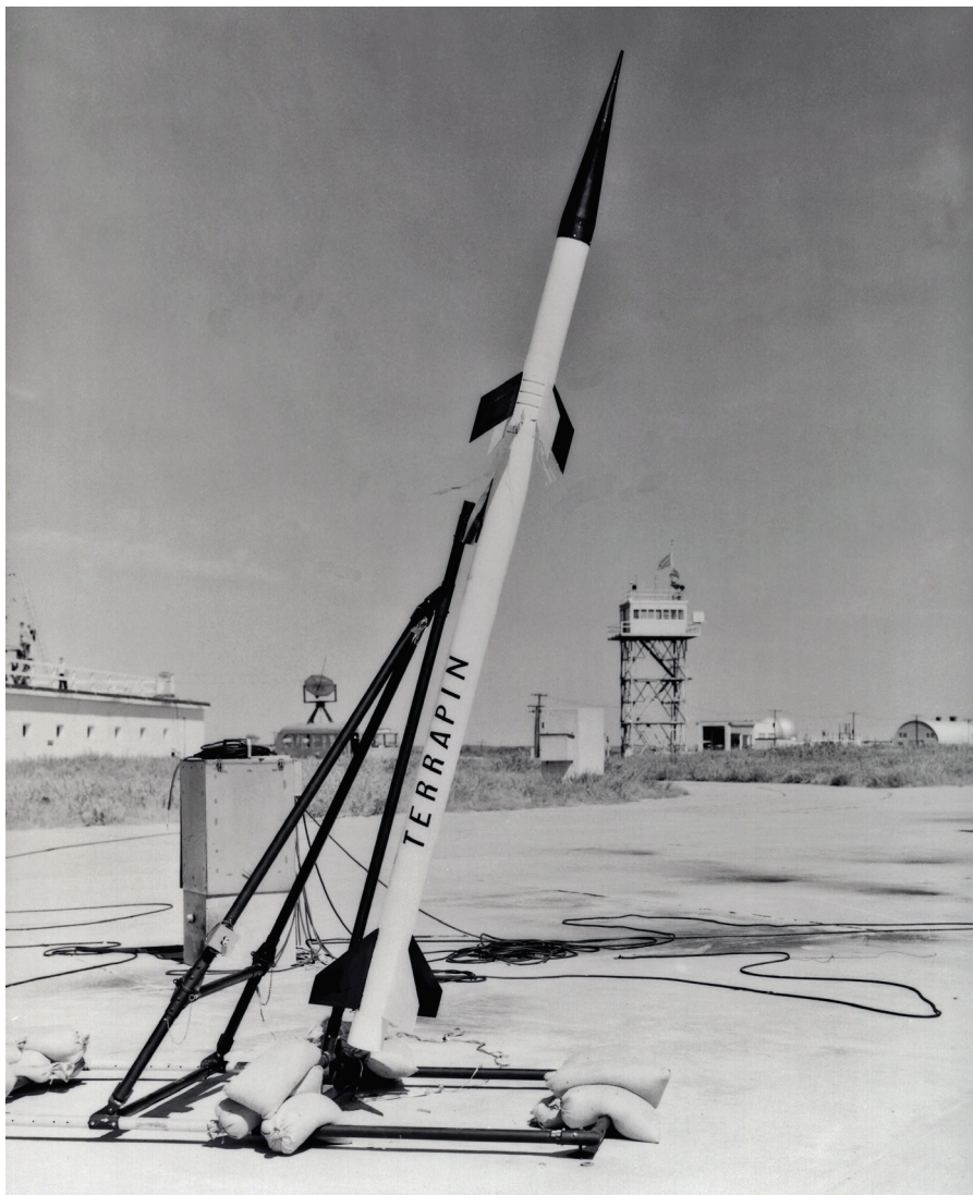
Dvostopenjska sondažna raketa terrapin (H121-2681-I) na lansirni napravi na vzletišču Wallops Island v Virginiji (Foto: NACA, Foster)
