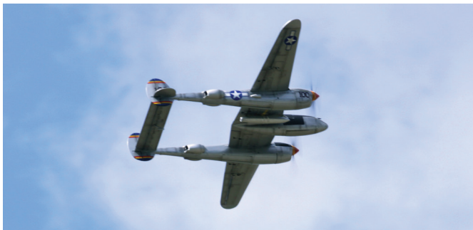
Maketa ameriškega lovškega letala P-38 lightning Jurija Batagelja. Čez krila meri 210 cm, poganjata pa jo dva elektromotorja.
