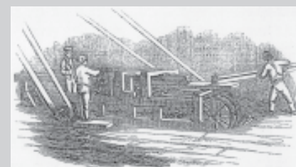
□ Slika 3. Stroj za izdelovanje žlebov. Ta stroj je prihranil veliko človeškega dela. Iz lesenega trama je stroj izdolbel žleb in dva kondenzacijska kanala. Razrezal je na 24 čevlje dolge kose ter jim od strani navrtal luknje za lesene mozničke (The Illustrated London News, 1850)
