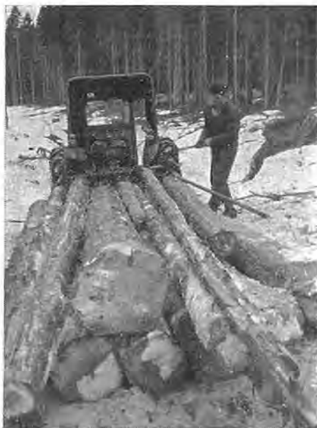
Slika 1. Levo: Vlačenje sortimentov po strmi vlaki navzdol s traktorjem Fe-35. Tovar je povečan z dodatnim pribijanjem hlodov. Desno: Pripenjanje, zabijanje sortimentov na traktorski drog
