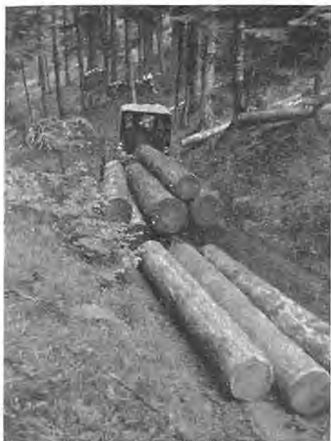
Slika 1. Levo: Vlačenje sortimentov po strmi vlaki navzdol s traktorjem Fe-35. Tovar je povečan z dodatnim pribijanjem hlodov. Desno: Pripenjanje, zabijanje sortimentov na traktorski drog
