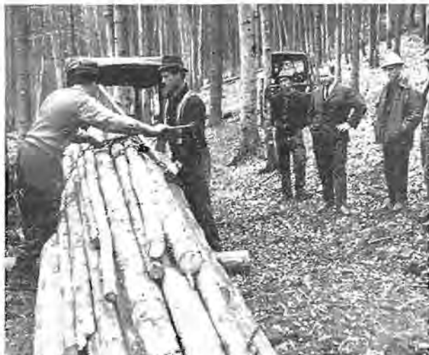
Slika 3. Napenjanje verige z vzvodom pri povezovanju tovora na traktorskem oplenu
