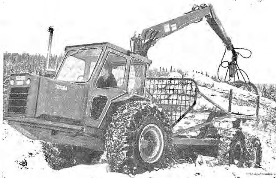
Slika 6. Traktor 826/836 s ploščadjo in žerjavom rabi za spravilo lesa po težavnih terenih
