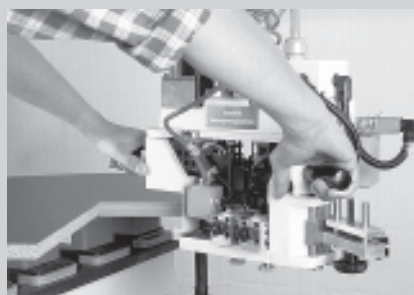
□ Slika 3 b. Obdelava manjših obdelovancev z vpetim agregatom
