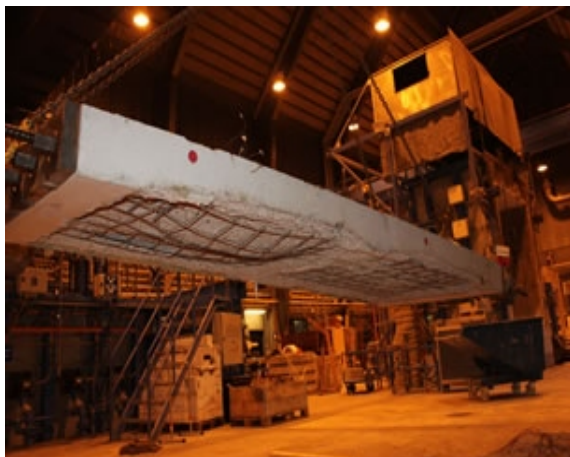
Slika 2.4: Posledice luščenja betona po požarnih testih (Fire spalling ..., 2013, Tunnel fire ..., 2013).
