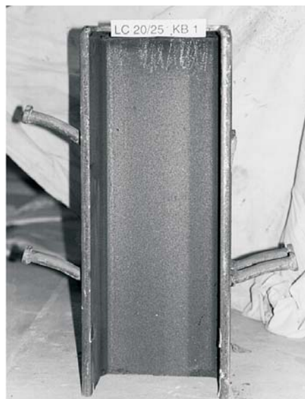
Slika 2.9: (a) Preizkušanelec pred testiranjem. (b) Mozniki po testiranju. (Faust, 1996)
