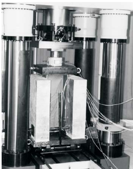
Slika 2.9: (a) Preizkušanelec pred testiranjem. (b) Mozniki po testiranju. (Faust, 1996)
