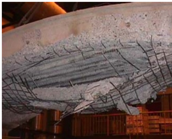
Slika 2.4: Posledice luščenja betona po požarnih testih (Fire spalling ..., 2013, Tunnel fire ..., 2013).
