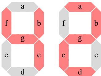
Sedemsegmentni prikazovalnik priklopimo na sistem Arduino takoj, kot bi priklopili sedem neodvisnih diod LED. Vsako od diod priklopimo na svojo izhodno digitalno sponko, pri čemer ne smemo pozabiti na zaščitne upore.
