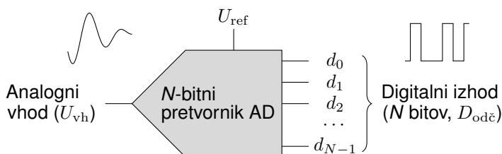
Kot je prikazano na gornji sliki, pretvornik AD vhodno napetost  $U_{vh}$  pretvori v  $N$ -bitno dvojiško vrednost  $D_{odč}$ , sestavljeno iz bitov od  $d_0$  do  $d_{N-1}$ . Pretvornik v postopku pretvarjanja primerja vhodno napetost z referenčno napetostjo  $U_{ref}$ , ki hkrati predstavlja
