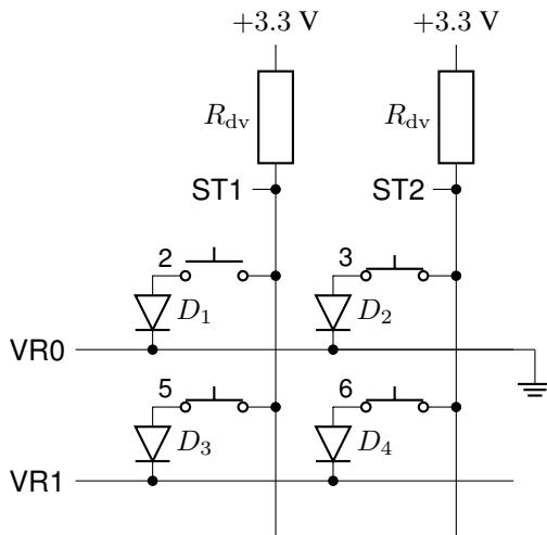
Slika predstavlja izsek matrične tipkovnice, ki jo uporabljamo že ves čas, z dodanimi izolacijskimi diodami. Čeprav so tipke 3, 5 in 6 še vedno pritisnjene, pa dioda D<sub>4</sub> zdaj preprečuje, da bi tok s sponke ST1 stekel proti ozemljitvi, s čimer ostane ta sponka na logični enki. To je tudi pravilno stanje, saj tipka 2 ni pritisnjena.
