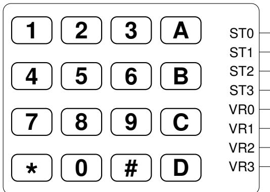
Matrična tipkovnica je pasivno vezje in je zgrajena izključno iz mehanskih tipk. Na naslednji sliki vidimo vezalno shemo gornje tipkovnice:
