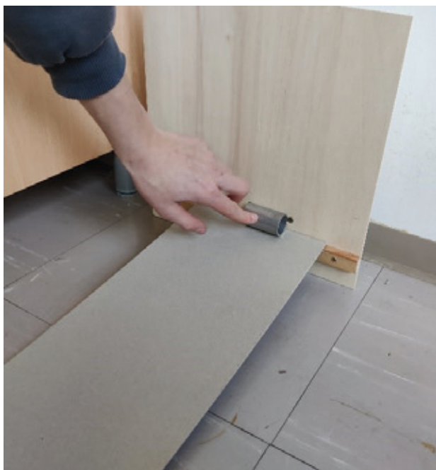
Slika 3: Prikaz poskusa s spuščanjem kovinskih tulcev po klanecu
