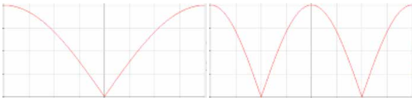
Slika 7: Prvi način nihanja stojećega valovanja (a) in drugi način (b).
