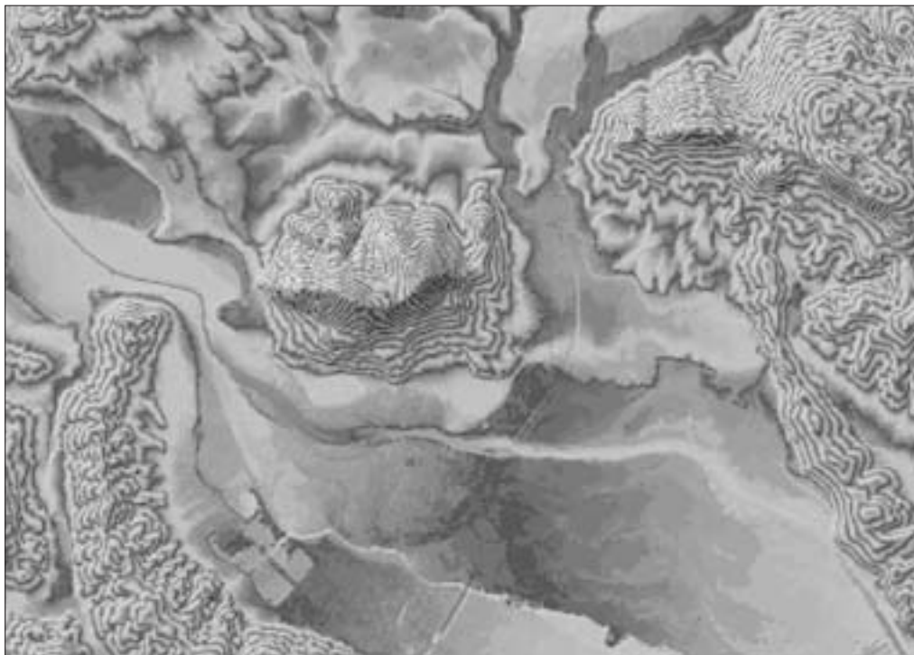
Slika 4: DMR Slovenije (DMV 20), prikazan s tehniko bipolarnega diferenciranja (originalno mora biti v barvah) in kombiniran s senčenjem, za območje Šmarne gore (8000 krat 6200 m). Posamezni interval (ekvidistanca) je 20 m.
