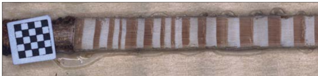
Slika 2: Del slike izvrtka duglazije z merilom pripravljena za merjenje
