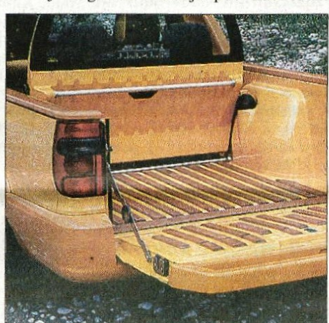
Tovorni prostor: deščice ščitijo pločevino pred odrgrninami.
