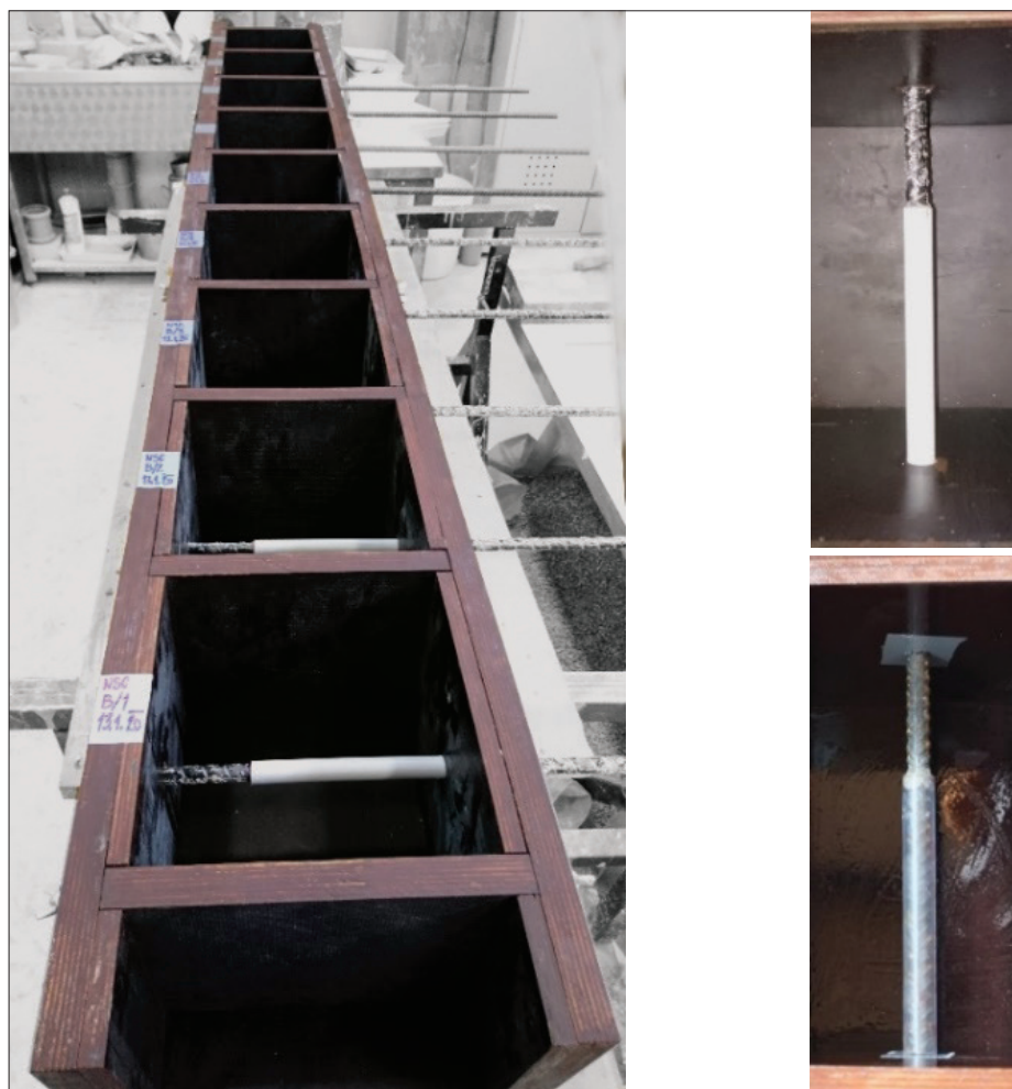
Slika 8 • Večcelični kalup, pripravljen za vgradnjo betona (levo), preprečitev sprjemnosti na delu bazaltne palice (desno zgoraj) in jeklene palice (desno spodaj).
