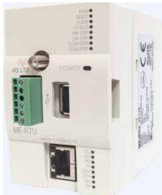
Slika 3 : Podatkovni vmesnik ME-RTU med oddaljeno napravo in nadzornim centrom v fazi komercializacije
