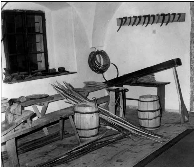
Sodarski oddelek: pripomočki za skobljanje dog in sestavljanje sodov. Foto: M. Mehora
