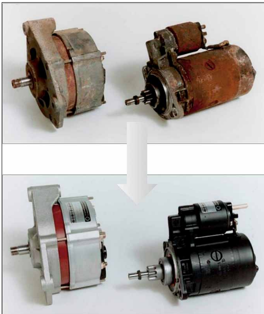
Slika 4. Obnova že uporabljenih strojnih delov (S. Schweinstig et.al, University of Bayreuth, Nemčija)
