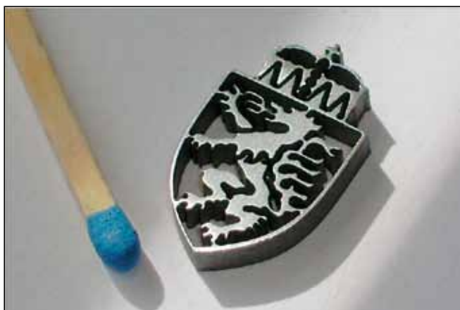
Slika 3. Emblem iz 3 mm nerjavečega železa izdelan z abrazivnim vodnim curkom. Uporabljen tlak 350 MPa, premer šobe za oblikovanje curka 0.12 mm, mešalna šoba premera 0.3 mm in pretok abraziva 80 g/min zrnatosti 220 (F. Trieb, BHDT, Avstrija)
