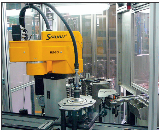
Stäublijev robot SCARA RS 60 pri sestavljanju turbinskega dela sesalne enote
