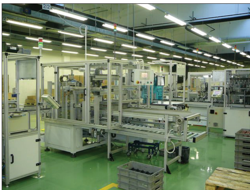
Najnovejša montažna linija sesalnih enot omogoča popolno sledenje sestavnih delov in končnega izdelka
