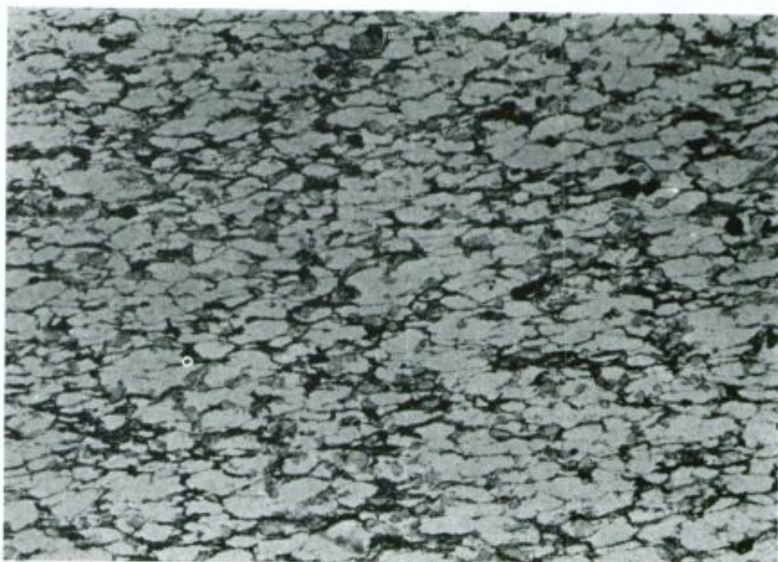
Sl. 5. Srednjeznata kaolinitna usedlina s pšenasto strukturo. Vezivo je sivo, piritna zrna pa so črna. Pri slepem jašku št. 16, II. obzorje, vzorec 5. Presevna polarizirana svetloba, povečava 7\times
