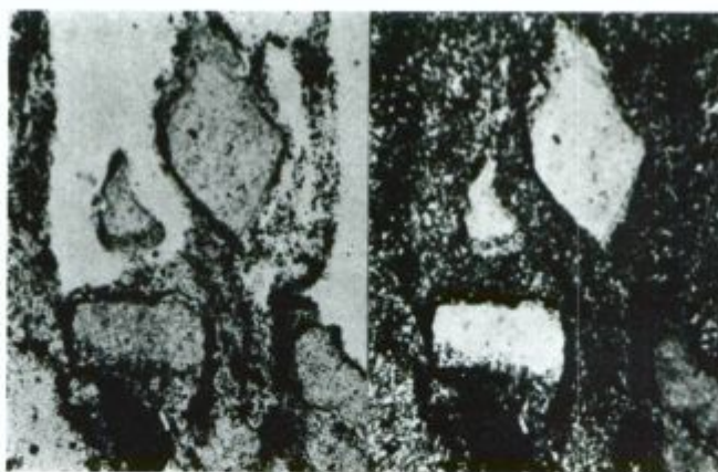
Sl. 10 levo. Drobnna piritna zrna obrobljajo siderit, leže pa tudi v kaolinitnem pšenu in v vezivu. Pri slepem jašku št. 16, II. obzorje, vzorec 5. Presevna polarizirana svetloba, povečava 75\times . 10 desno. Pri navzkrižnih nikolih so sideritna zrna bela
