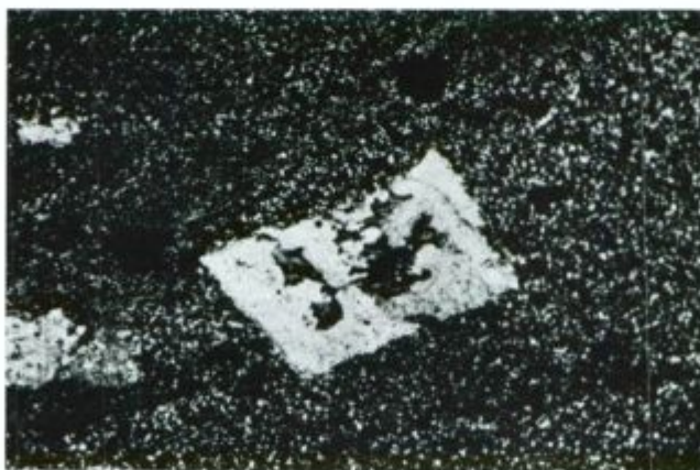
Sl. 8. Idiomorfni siderit (sredina slike) z vključki kaolinita v mikrokristalnem kaolinitu. Rudno telo Brus, II. obzorje, 2. etaža. Presevna polarizirana svetloba, navzkrižni nikoli, povečava 75 ×
