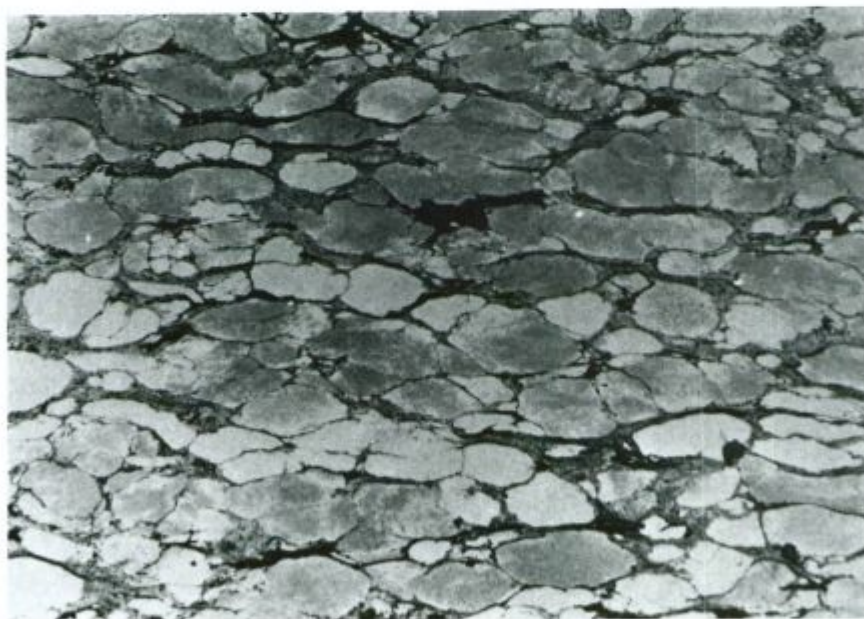
Sl. 4. Debelozrnat kaolinitno usedlino grade predvsem zrna s pšenastim in eliptičnim presekom; veziva je le malo. Črno je pirit. Presevna polarizirana svetloba, povečava 5×. Rudno telo Hangend, VII. horizont, 7. etaža, vzorec 3
