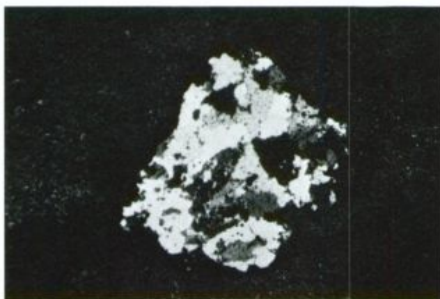
Sl. 17. Isto kot sl. 16, navzkrižni nikoli. Zobčasto zraščena, enako velika kremenova zrnca
