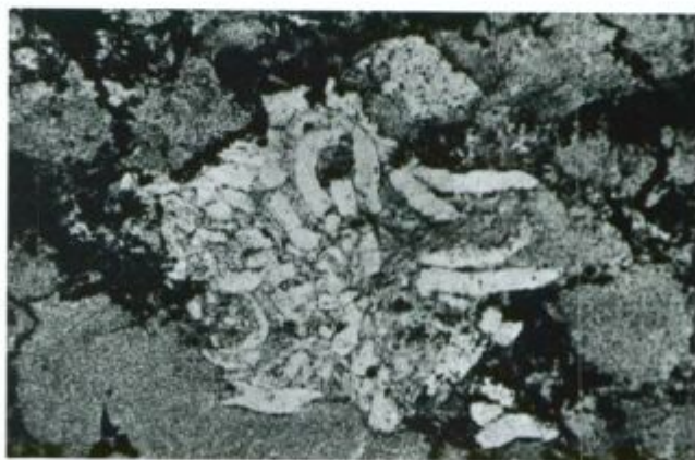
Sl. 6. Kaolinitna zrna s črvičastimi preseki v kriptokristalnem kaolinitu. Rudno telo Hangend, VII. obzorje, 4. etaža, vzorec 4. Presevna polarizirana svetloba, povečava 30\times
