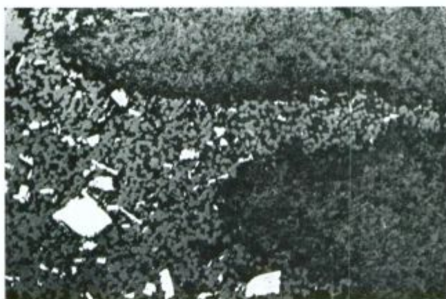
Sl. 13. Detajl iz istega obruska. V vezivu vidimo pravilno razvrščena, drobna kremenova zrnca (sivo). Bela zrna so pirit. Odsevna polarizirana svetloba, povečava 190 \times Abb. 13. Detail aus demselben Anschliff. Im Bindemittel befinden sich regelmässig verteilte, kleine Quarzkörner (grau). Weisse Körner sind Pyrit. Nicols —, Vergrößerung 190 \times
