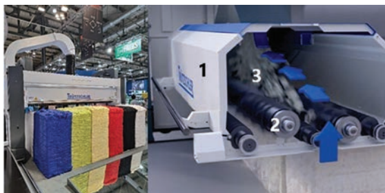
Slika 3: Rahljalik bal BLENDOMAT BO-P izdelovalca Trützschler (levo) in prikaz rahljalnih enot rahljalnika bal (desno): 1 – ohišje rahljalnika bal, 2 – rahljalna enota (valj), 3 – zrahljano predivo (kosmi in kosmiči) [6]
