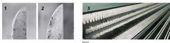
Slika 9: Prikaz obloge po mikanju 240 ton prediva: 1 – prikaz mikalne obloge s sistemom IGS, 2 – prikaz mikalne obloge brez sistema IGS, 3 – prikaz brusilnega sistema IGS [5]
