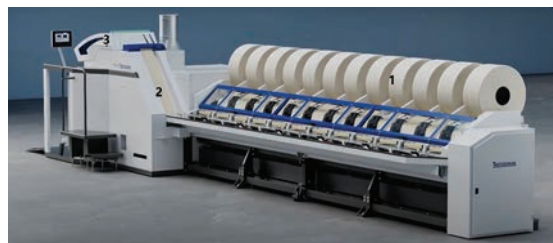
Slika 19: Česalnik TCO 21XL z loncem JUMBO: 1 – svitki (12 navitkov), 2 – združevanje česanih pramenov, 3 – raztezalo [8]
