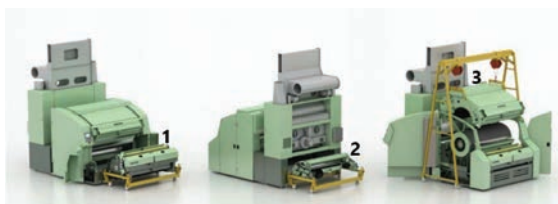
Slika 10: Prikaz preproste menjave posameznih delov mikalnika C77: 1 – prikaz menjave snemalnega valja, 2 – prikaz menjave dovajalnega in rahljalnega valja, 3 – prikaz menjave pokrovčkov [5]
