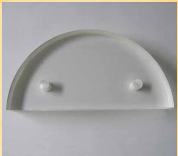
Slika 2: Homogeni fantom iz 2,42 cm debelega pleksi stekla
