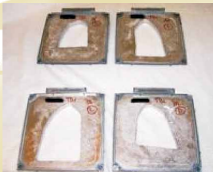
Slika 12., 13. in 14: Izdelava individualnih zaščit za področje pljuč ter izdelane individualne zaščite za obsevanje TBI ter negativ za obsevanje predela pod zaščitami z elektroni
