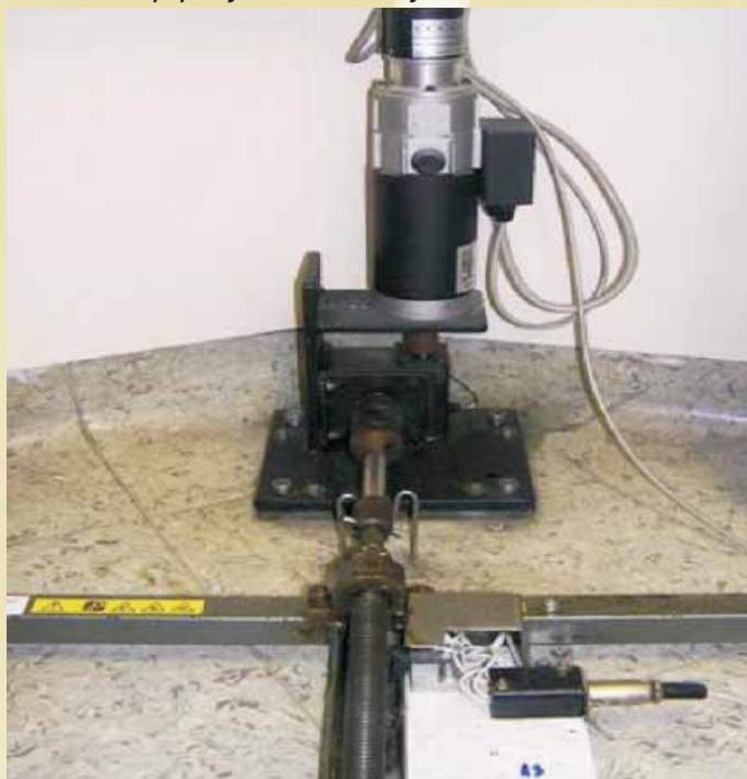
Slika 4: Motor, ki pomika voziček skozi obsevalni snop
