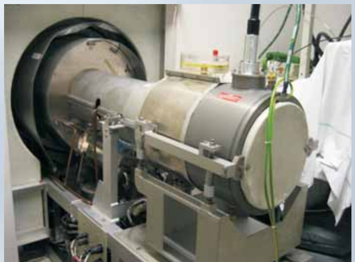
Slika 6: Zadnji del skenirne cevi (elektronski top oz. katoda) (C-150), (LKH Graz).
