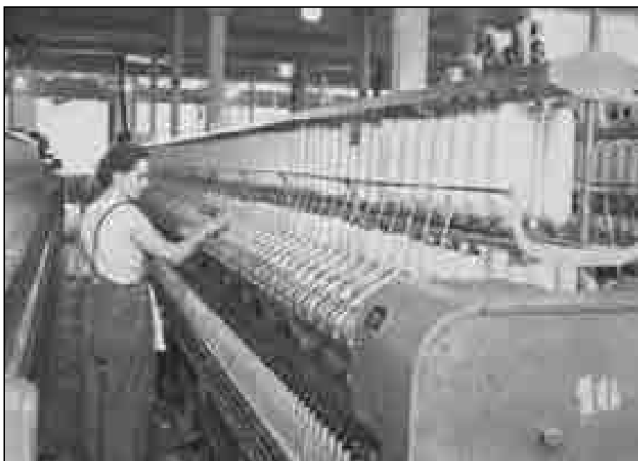
Predica pri rekonstruiranem prstančnem stroju SACM leta 1969 (Kresal, Predilnica Litija 90 let, str. 69).
