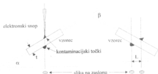
Slika 4. Merjenje debeline vzorca s kontaminacijskimi točkami
