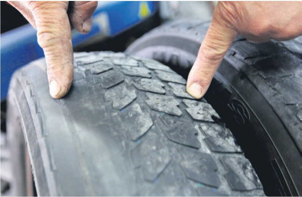
Tipičen primer obrabljenih in nevarnih pnevmatik, če optika na vozilu ni nastavljena tako kot je treba.
