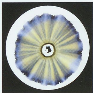
Kromatografija dveh črnih flomastrov različnih proizvajalcev.
