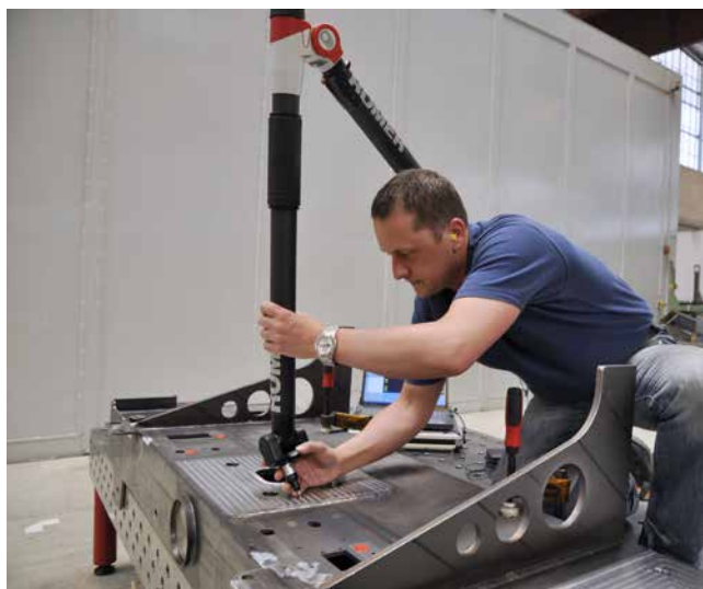
» Dimenzijska kontrola podporne plošče spojke za tramvaj.
