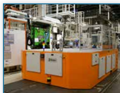
160 SMED spodbuja povpraševanje po avtomatskih transportnih sistemih za orodja
