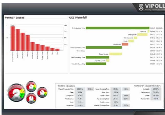
» Model vodopad-dijagrama. Dijagram prikazuje performanse stroja ali linije primenom dinamičnih variabli u zenon-u.
