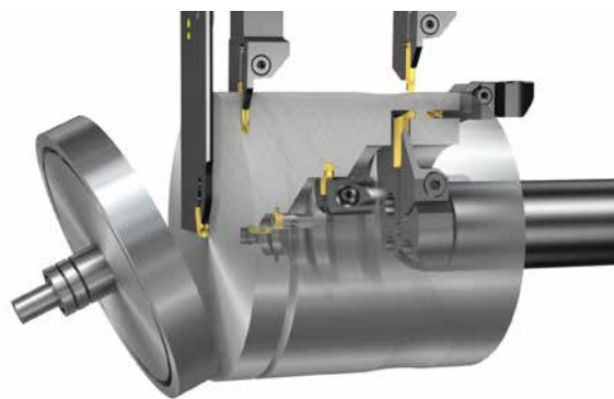
» Slika 4: Odrezovanje in izdelava utorov - CoroCut QD, 1-2, Q-Cut, MB, XS
