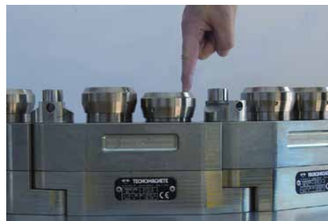
» Slika 3: Izravnalne podloge za neravne obdelovance preprečujejo deformacijo obdelovanca.
