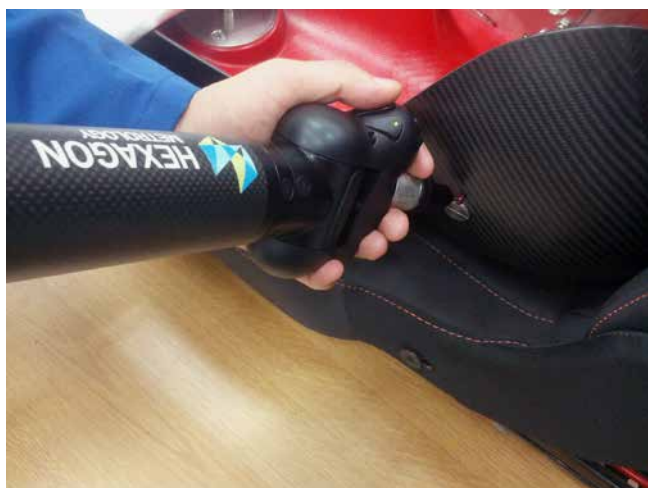
» Merjenje jeklenega okvirja sedeža z DEA GLOBAL Silver Performance CMM proizvajalca Hexagon Metrology
