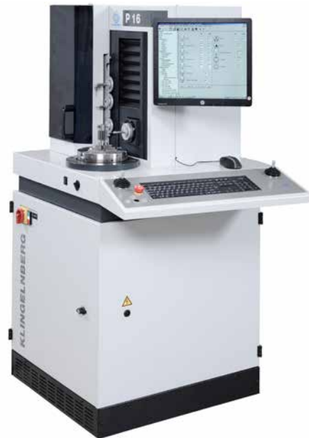
» Slika: Merilni center P 16 – posebej prilagojen za meritve majhnih kosov
