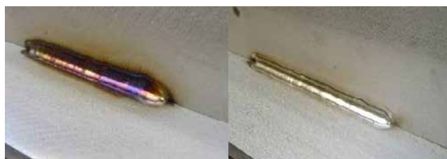
» Slika: Varjenje nerjavne pločevine po TIG-postopku, zaščitni plin argon (levo) in trikomponentna mešanica (desno)
