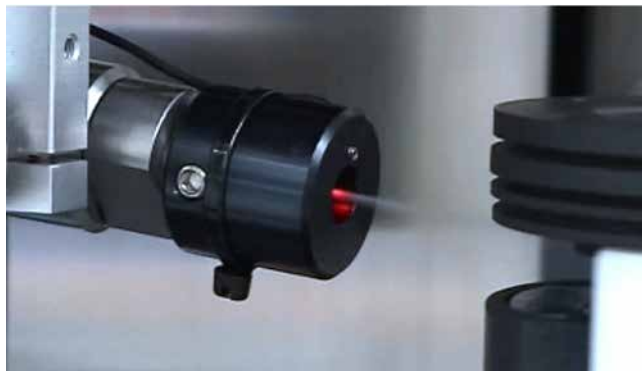
» Slika 2: ACI QuattroClean, curek tekočega CO 2
