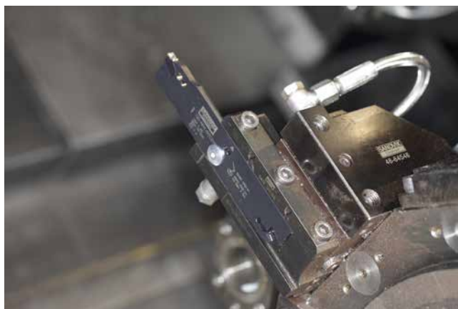
» Slika 1: Koncept globokega odrezovanja CoroCut QD izkorišča visokotlačni curek hladilne tekočine pod tlakom (Pablo 140315).
