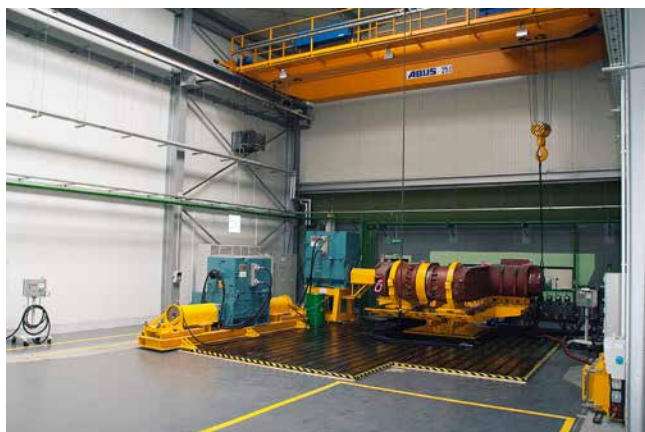
» Pregled merilnega sistema za preizkušanje rok strojev za čelno odkopavanje premoga
