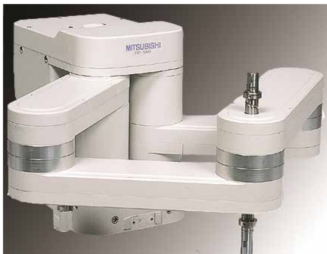
» Mitsubishi Electricov robot SCARA RP-5ADH z dvojno roko, namenjen za mikrorokovanje v najrazličnejših procesih
