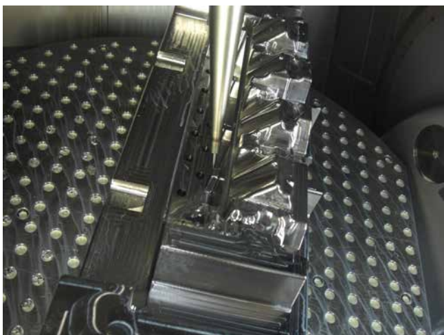
» Fina obdelava velike osnovne enote orodja na visokozmogljivem petosnem obdelovalnem centru C 60 U
