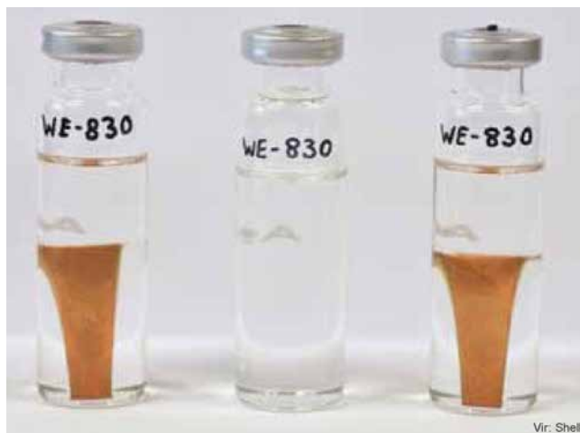
» Slika 3: Shellova bazna transformatorska olja GTL se lahko uporabljajo vzporedno z običajnimi olji. Slika prikazuje zmes Shellovega transformatorskega olja Shell Diala S4 ZX-I po 144 urah pri 100^{\circ}\text{C} , levo: z bakrom v zatesnjeni posodi, na sredini: starano brez bakra in na desni: staran z bakrom v nezatesnjeni posodi.
