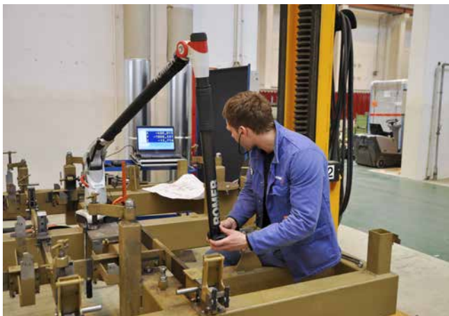
» Z merilnim območjem 4m merilna roka ROMER doseže vse pomebne točke na pripravi.
