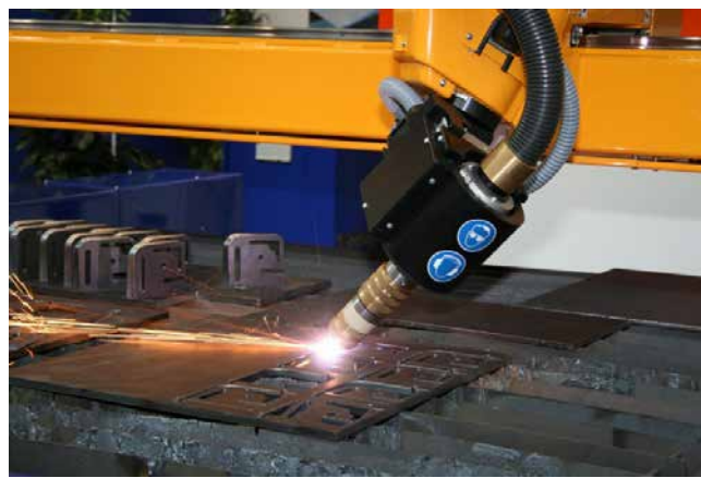
» Slika 2: Rotacijska glava za plazemsko rezanje pod kotom z neskončno rotacijo, inteligentnim nosilcem gorilnika in avtomatsko kalibracijo geometrije
