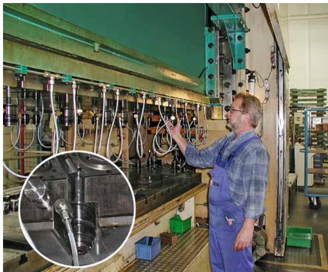
» Pri uporabi vpenjalnih cilindrov na pahu stiskalnice ni nobenih preprek pri nameščanju orodij (Slika: ROEMHELD).
