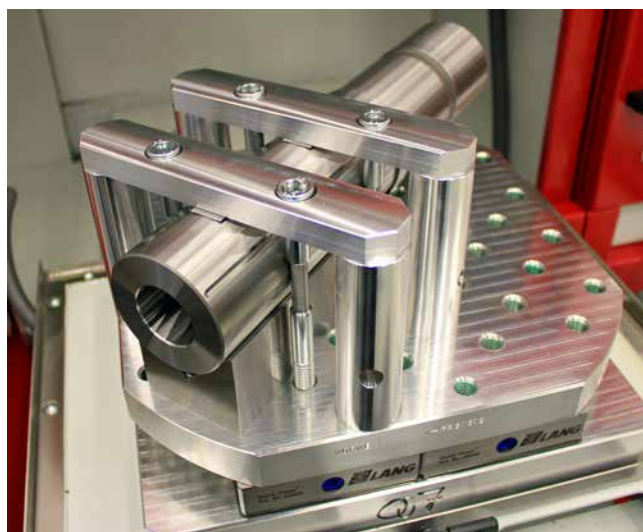
» To inteligentno zasnovano vpenjalo omogoča obdelavo izvrtine v votli gredi z notranjim cilindričnim brušenjem do globine 100 mm z obeh strani in tako odpravlja obdelavo na stroju za notranje cilindrično brušenje v dveh vpetjih. (Fotografija: Klaus Vollrath)
