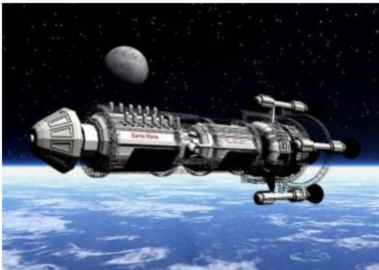
V orbiti sestavljena vesoljska ladja, v kateri 90% prostora zasedajo rezervoarji za gorivo (po predlogu NASA).
