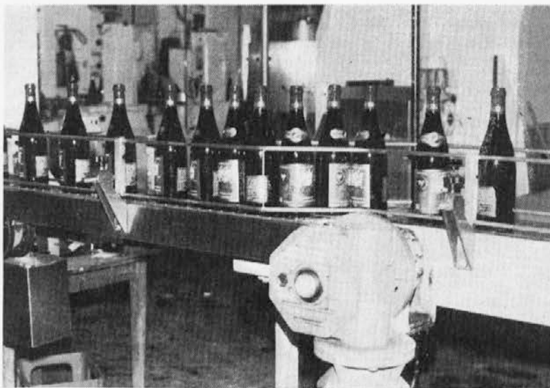
Kapaciteta polnilnice je 2200 steklenic na uro. To je nova linija, uvožena iz Italije, na kateri so okvare minimalne. Prednost linije je tudi v tem, da so njeni nadomestni deli lahko dosegljivi.
