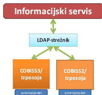
Slika 1: Osnovni koncept prijavnega mehanizma COBISS preko protokola LDAP
