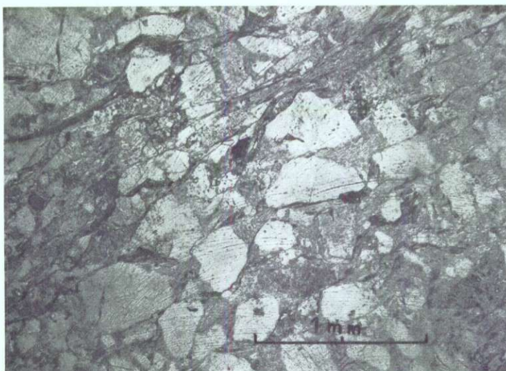
Sl. 7. Klivažne razpoke v grödenskem peščenjaku. Mikroskopska fotografija jedra iz vrtnice B-11 na globini 404 m.
