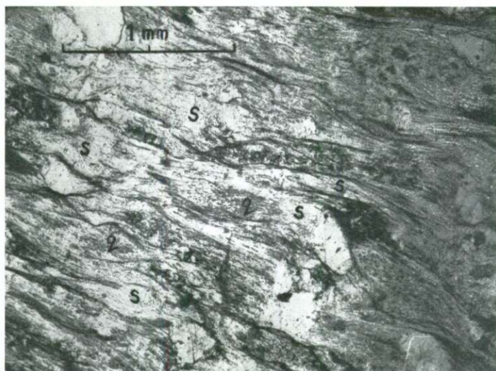
Sl. 8. Mikroskopska fotografija grödenskega peščenjaka. Dobro izražena klivaža z novimi minerali. S sericit, q kremen. Vzorec No. 9923 iz kamnoloma ob cesti na Žirovski vrh.
