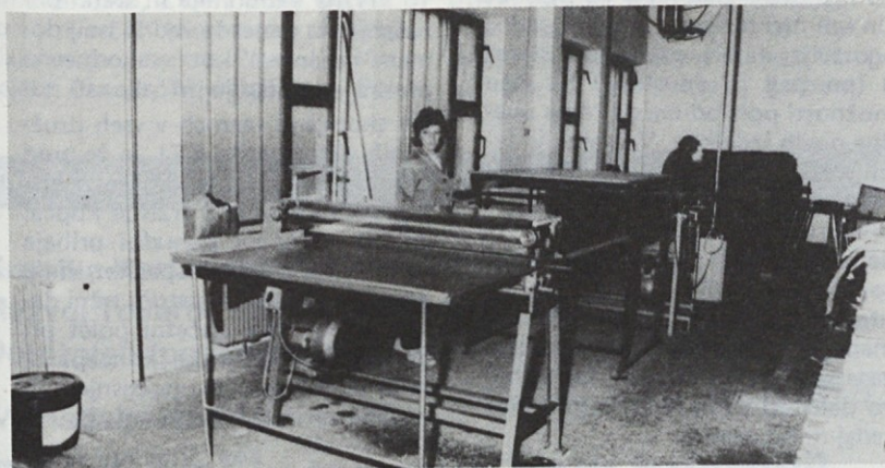
Prva poizkusna proizvodnja na novem stroju za kaširanje valovitega kartona v tozdu Kartonaža Rakek
