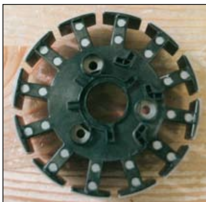
Slika 2. Zabrizgani stator po novi tehnologiji
