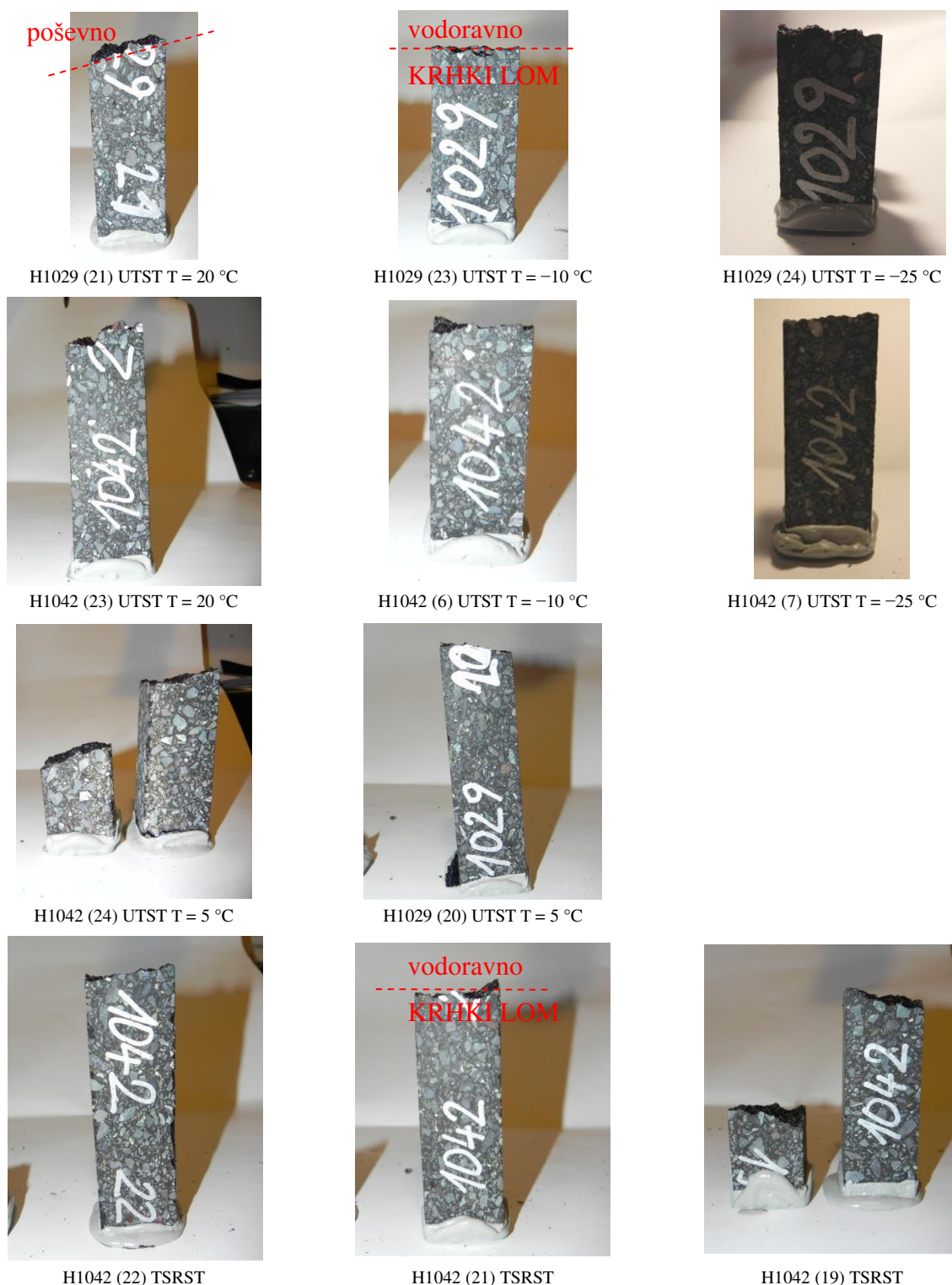
Slika 4.2.3: Prerez porušitve preskušancev H1029 (sestava 3; 5,4 m.-%) in H1042 (sestava 1; 4 m.-%) of bitumenizirane zmesi AC 8 surf
