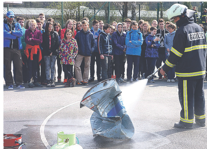
Če paro v zaprtem sodu ohladimo, se sod zloži na žepno velikost.
