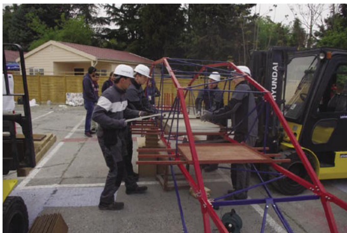
Slika 15 • Obremenitev mosta z jeklenimi ploščami mase 1000 kg
