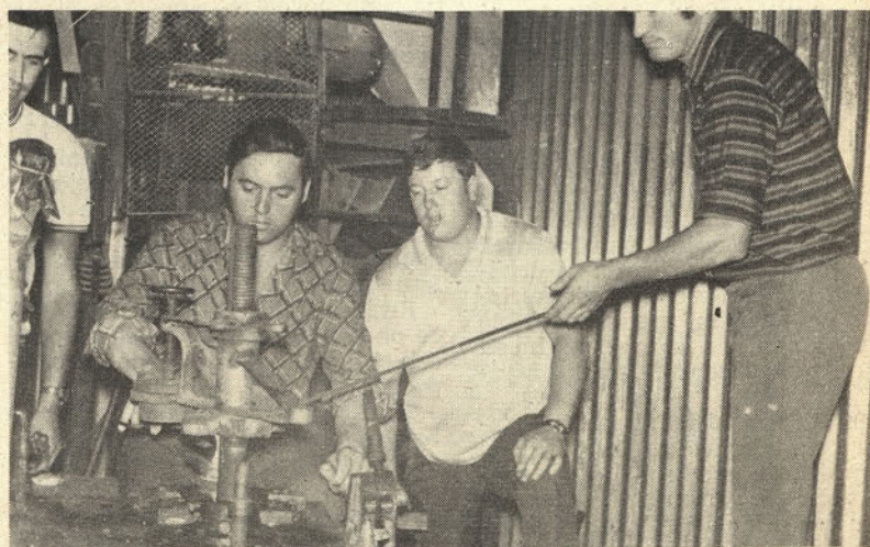
Izdelava kozarcev na stroju MDBO — podmornica. Slušatelji steklarske šole so morali pokazati znanje tudi tukaj
