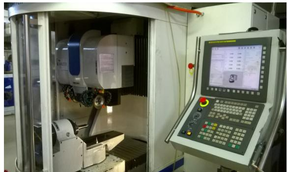
Fig. 4. Helectronic mini power grinding machine
