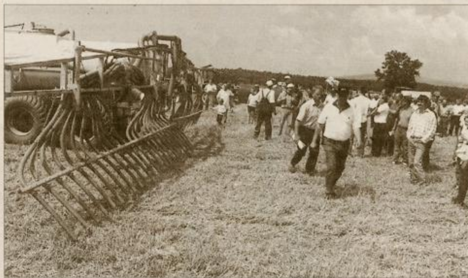
Med predstavitvijo delovanja cisterne Eisele z napravo za enakomerno razdeljevanje gnojevke. Foto: M.Ozmec
