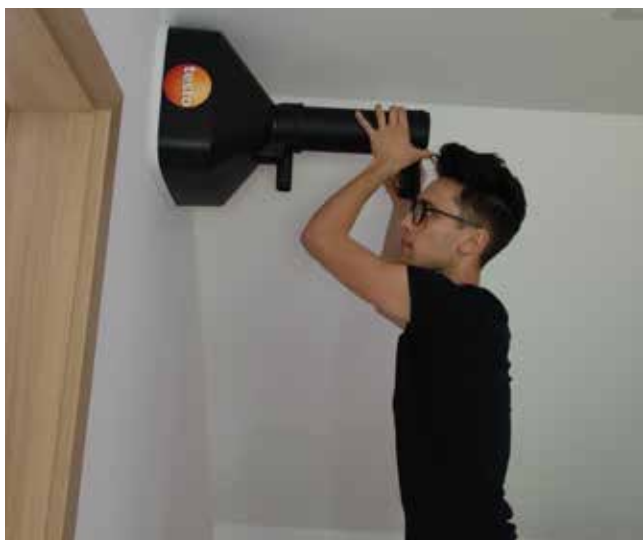
Slika 8 : Izvajanje meritev pretoka zraka z lijakom
